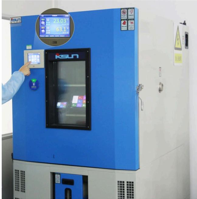
图 3-3 高低温老化测试图
