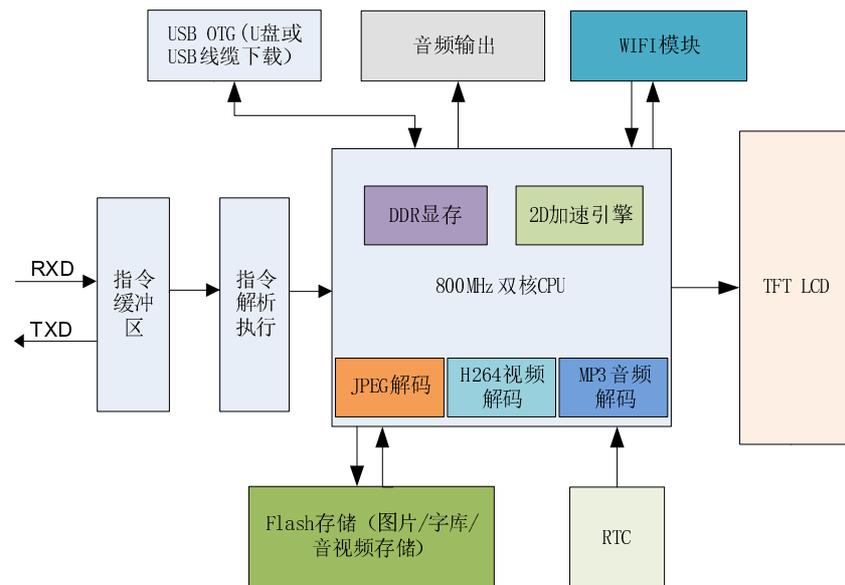
图 8-1 物联型串口屏内部结构图
